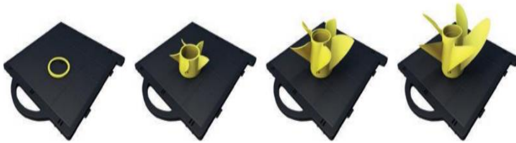
شكل (2-2) يوضح عملية الطباعة ثلاثية الأبعاد لأحد المنتجات بوضع طبقات رقيقة متتالية من المادة (الخام) الخاصة بالطباعة فوق بعضها البعض حتى يكتمل شكل المنتج المطلوب. المصدر: حشاد وعبدالعزيز (2016)
